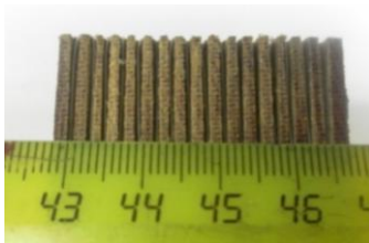
Рис. 3. Шаг навивки нихромовой проволоки в виде «змейки»
